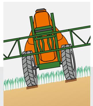
Avec correction automatique de dévers de l'essieu : le pulvérisateur reste dans les traces
