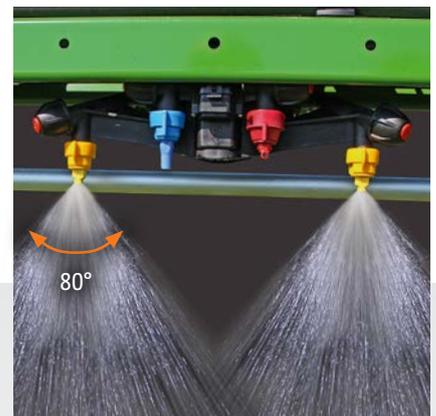
Coupure électrique buse à buse AmaSelect avec quadrijets et écart entre buses de 50 cm ou 25 cm
