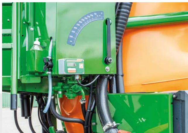
UX 5200 Special avec pack Confort et affichage digital du niveau de la cuve principale
