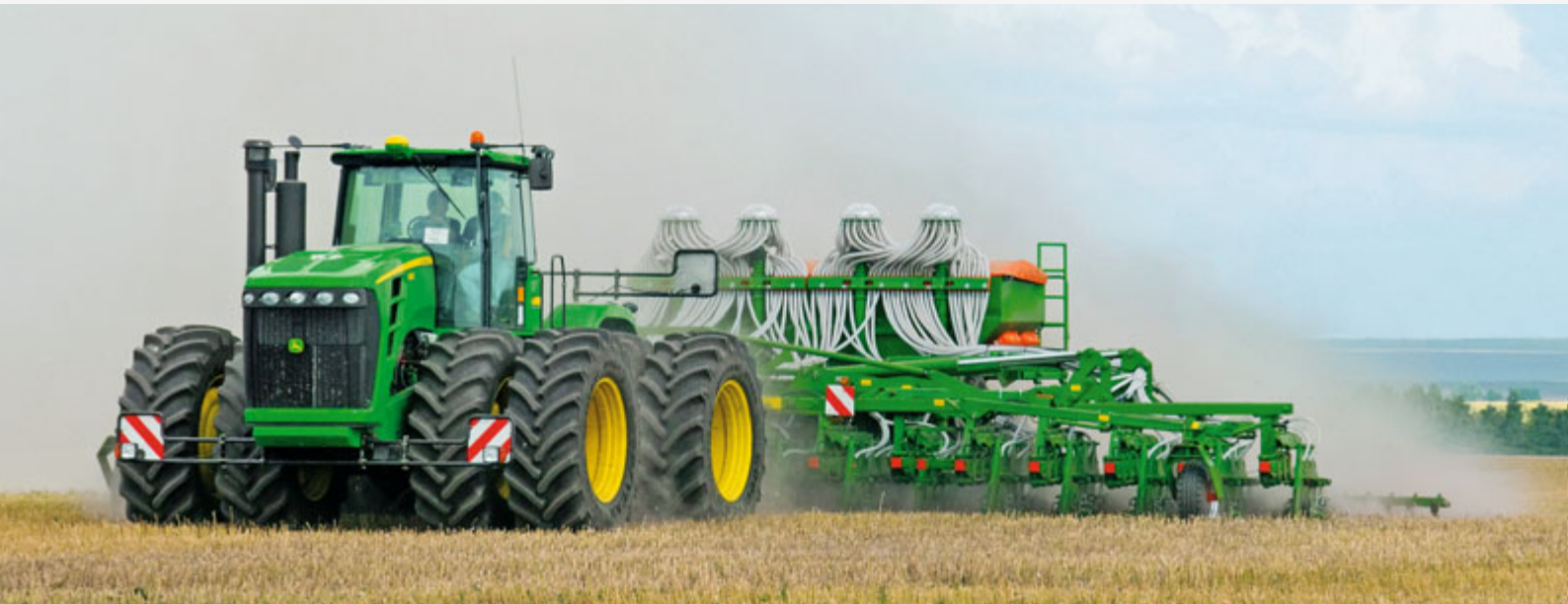
Primera DMC 12000-2C, largeur de travail 12 m
