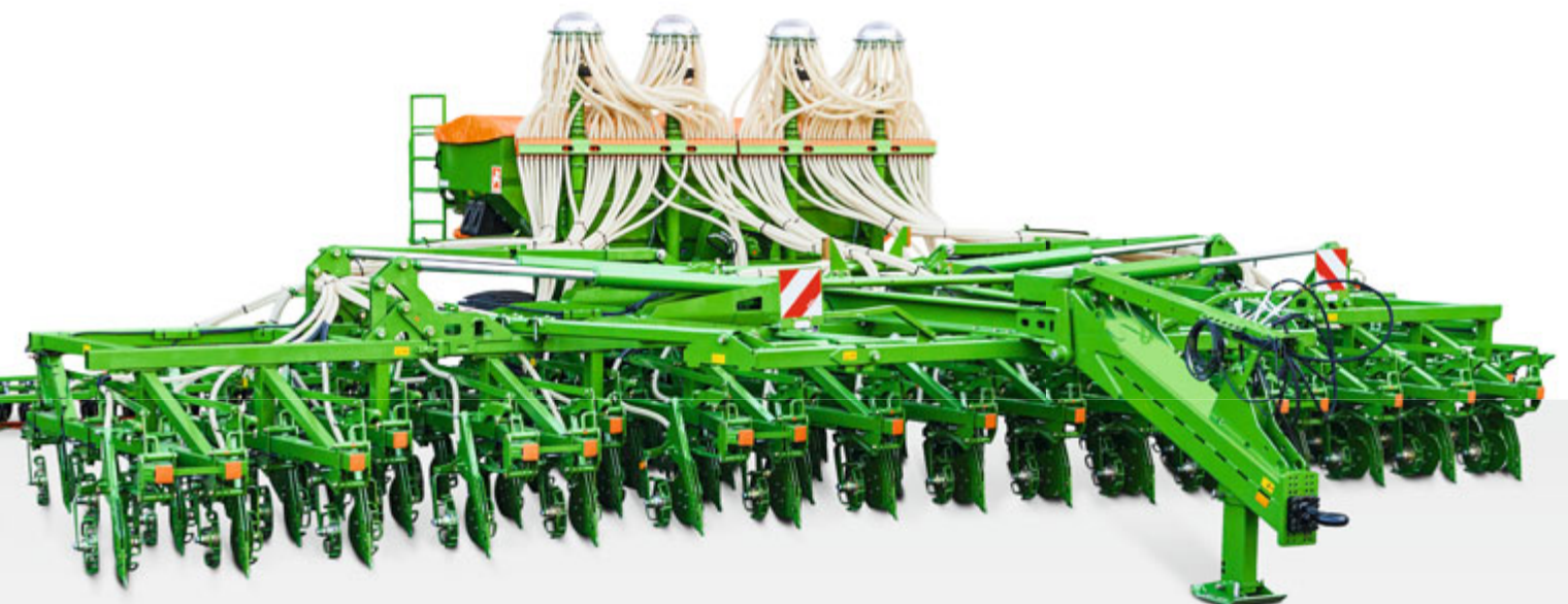
Primera DMC 12000-2C, largeur de travail 12 m
