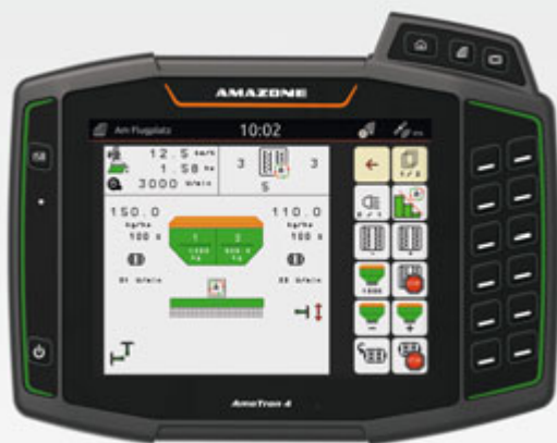
Terminal ISOBUS AmaTron 4 AMAZONE avec écran tactile 8 pouces
