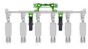
6 rangs grâce aux roues d'appui entre les rangs
