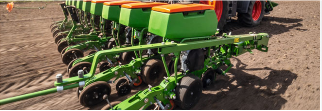
Trémie de semence logée au-dessus du sélecteur
