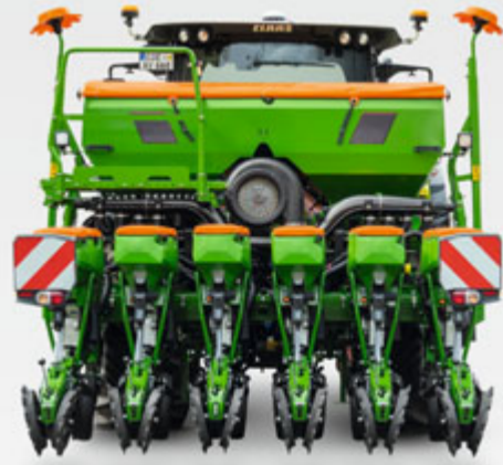
Precea 4500-2CC avec châssis télescopique variable avec réglage minimum de l'interligne
