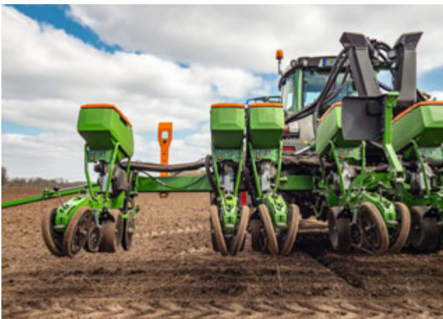
Inter-rang important pour créer un jalonnage avec élément déporté
