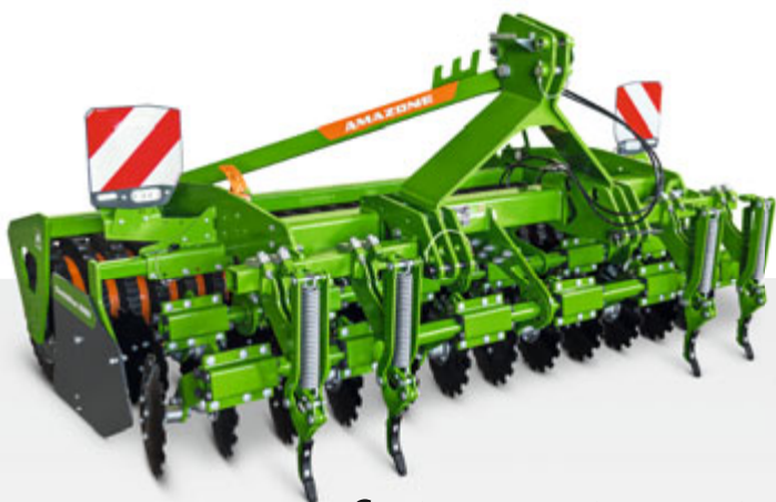
✔ Préparateur de sol à disques indépendants porté CombiDisc
