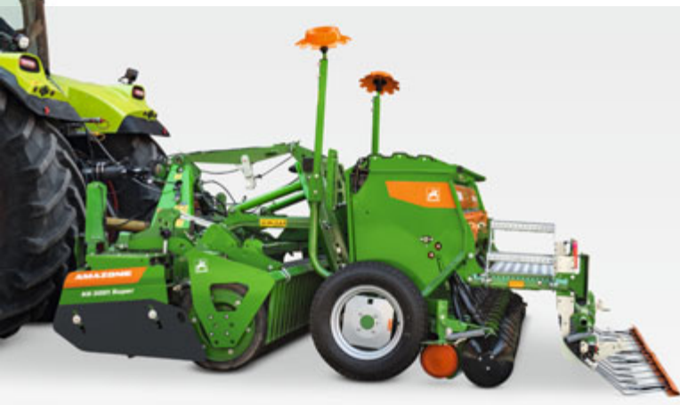
Cultivateur rotatif KG 3001 Super avec système Portacourt et semoir porté accouplé D9 3000
