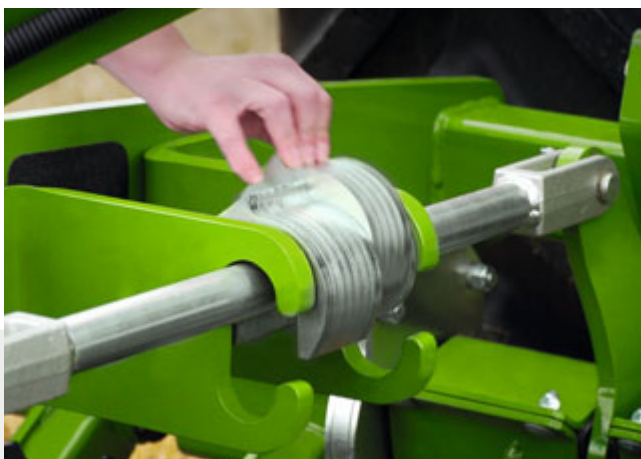
Réglage de la profondeur de travail grâce aux butées amovibles – Ici travail superficiel
