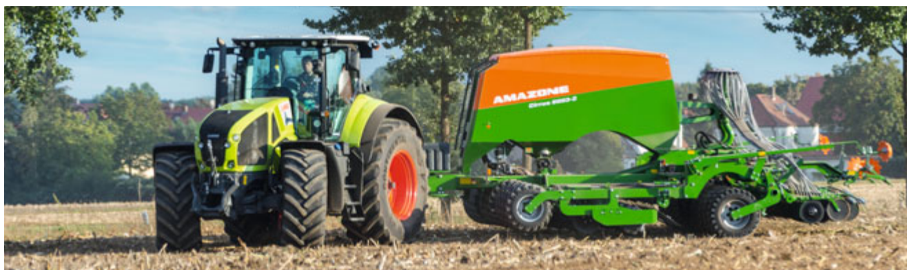
Cirrus 6003-2 avec trémie de semence un cône
