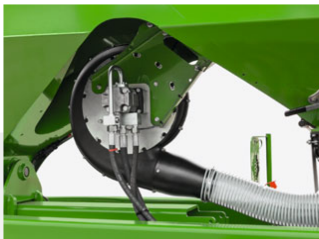
Entraînement hydraulique de turbine
