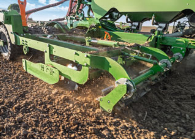
Le rouleau couteaux comme outil agressif en amont pour le Cirrus 6003-2
