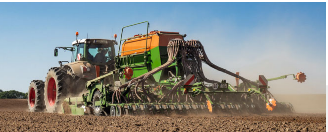
Utilisation du rouleau couteaux pour réaliser un lit de terre fine pour le semis du blé
