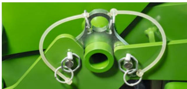
Pièce d'accouplement rapide QuickLink garantissent un accrochage et un décrochage fiable, rapide et sans outil.
