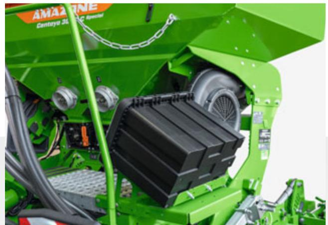
Caisse de transport d'une capacité de 41 l
