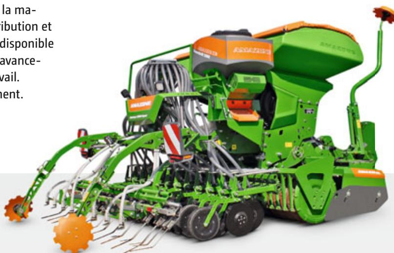
Implantation d'intercultures et de cultures dérobées avec le semoir intégré universel GreenDrill 200-E par diffuseur
