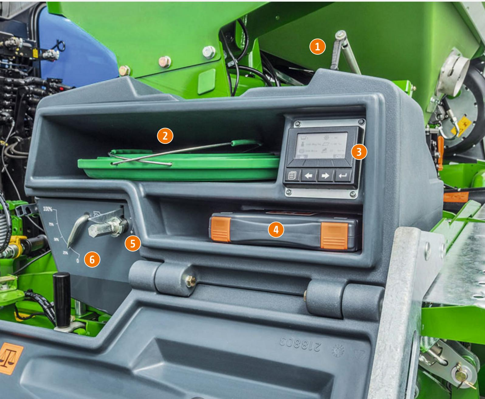
SmartCenter sur le Centaya 3000 Super avec double disque TwinTeC et réglage hydraulique de la pression de terrage des disques
