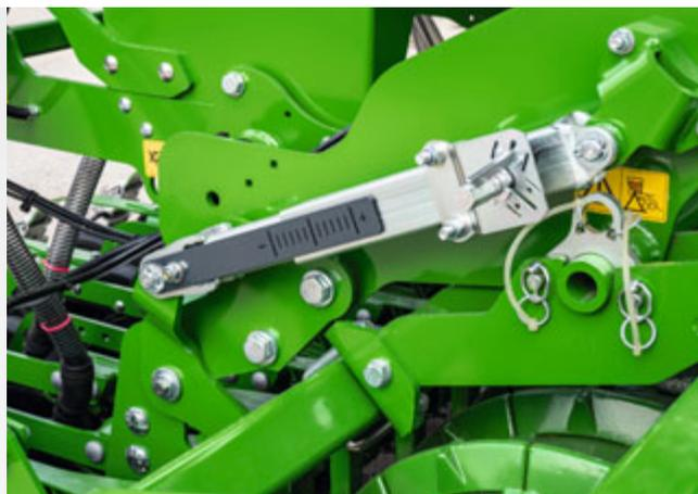
Réglage simple de la profondeur de semis sur le côté de la machine
