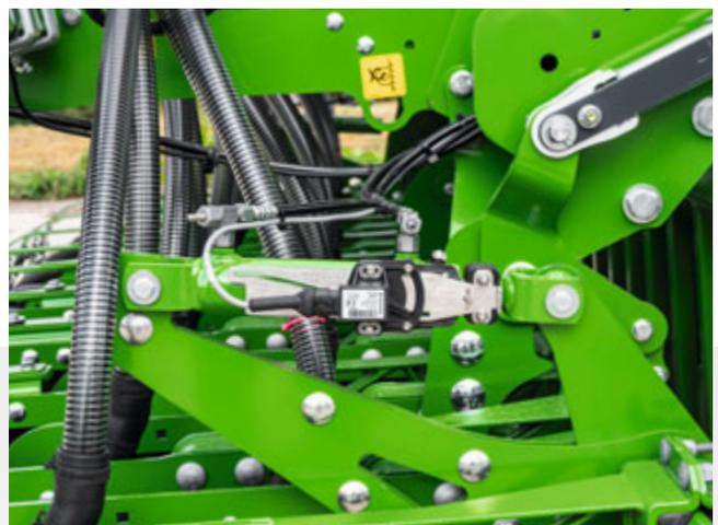
Vérin pour le réglage hydraulique de pression de terrage
