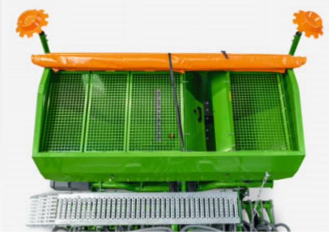
Une tôle permet de modifier rapidement la répartition des compartiments
