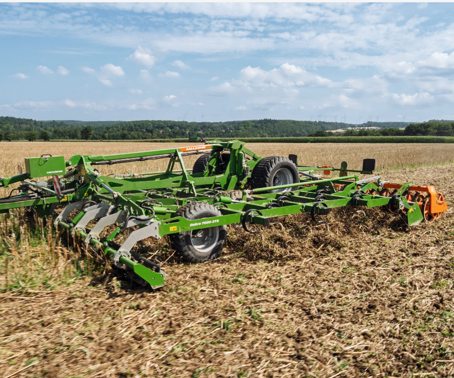
Cobra 7000-2TX avec rouleau hacheur
