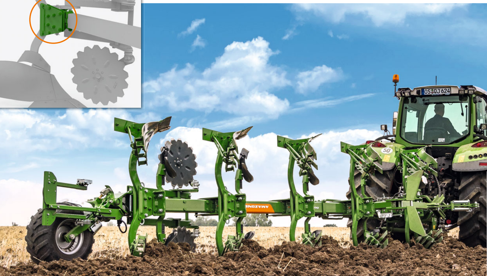
Sécurité anti-pierre par boulon de cisaillement
