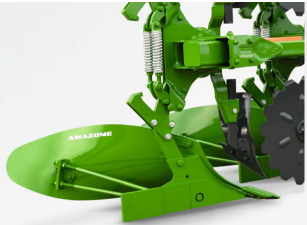
Sécurité anti-pierre semi-automatique
