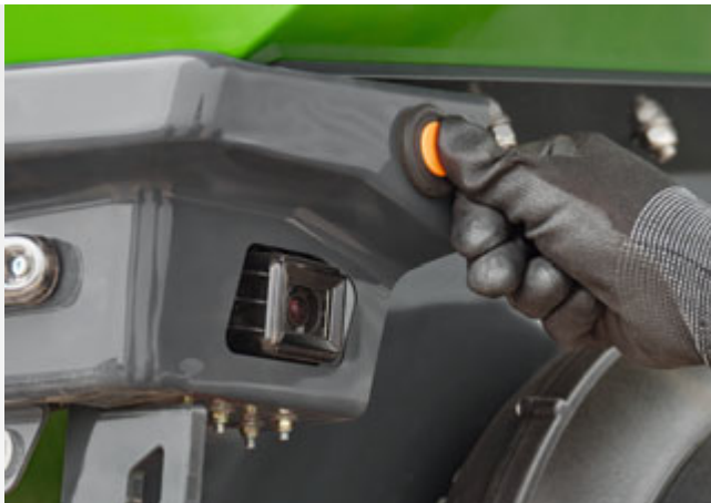
Étalonnage par simple appui sur un bouton
