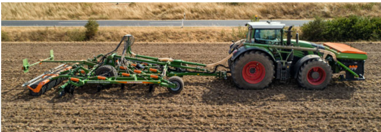
Trémie frontale FTender 1600 avec déchaumeur traîné Cenius-2TX
