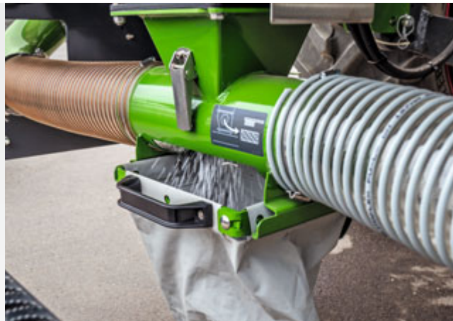
Le sac d'étalonnage est accroché confortablement en dessous de l'unité de distribution
